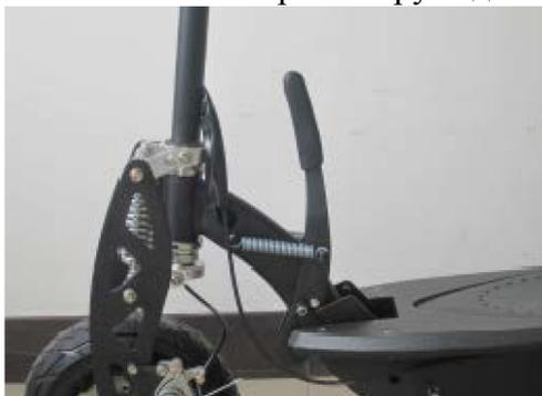
4. Присоединить руль, вставляя хомут руля в рулевой штырь до положения чуть ниже верха. Ориентировать руль в правильное положение с ручкой управления скоростью справа от водителя. Зафиксировать руль на рулевом штыре, затягивая болты хомута шестигранником, как показано на рисунке.
